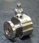
RF-BPM | ◎HOM-Free 型 RF-BPM<br><br>分解能 < 1 $\mu$ m<br>原点精度 < 10 $\mu$ m を達成                                                                                                                  | ◎Q-BPM, Structure BPM, Undulator BPM, として SCSS に実装 <ul style="list-style-type: none"> <li>・量産化、信号処理回路の低価格化</li> <li>・マルチバンチ化</li> </ul>                                                      |
