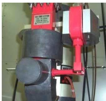
図 2 : クライストロン PV-3030A1 のイオンポンプ引き口の様子。内径 15mm の円筒ダクトを直角に 2 回曲げて ANELVA 製 8ℓ/s イオンポンプへ繋げている。RF 窓上流部の実行排気量はおおよそ 1.2ℓ/s。
