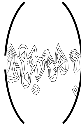
図 5: 発振器による FPR 内部電界 (鏡面間隔 107mm)
