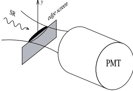
Figure 3: Edge detector scheme.
