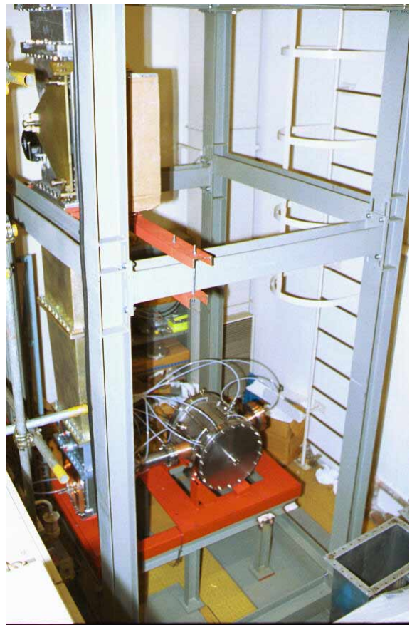
写真2 : 試験装置 (サーキュレーター、導波管、カップラーおよびRF空洞)
