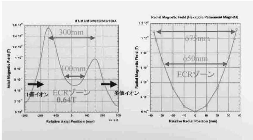
図 2 : ミラーコイルによる軸上磁場分布 (左) と 6 極磁石による径方向磁場分布 (右)
