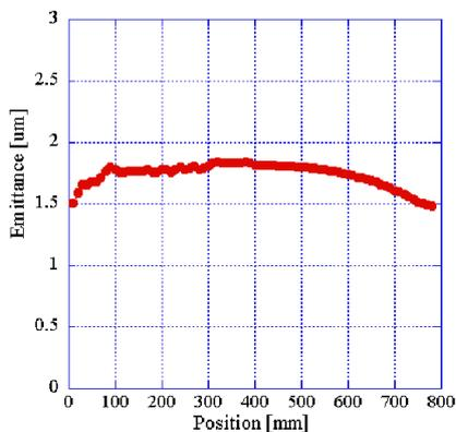
図 5 は、進行方向に対するエミッタンスの変化を示している。エミッタンスが、RFGun 空洞内で一度増加するが測定位置ではほぼ同じ値に戻っておりソレノイ
