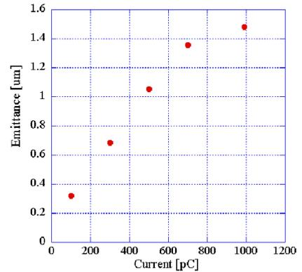
図 6 は、電荷量を変化させた時のエミッタンスの変化を示している。電荷量を減少させたときは、その都度レーザースポットサイズ、RF 位相、ソレノイド磁場の調整を行い最適化した。またレーザースポットサイズも先に仮定したように最小半径を下回らないよう注意した。RFGun 単体では難しい  $1\pi\mu\text{m}$  以下のエミッタンスを小電流域で生成出来ることが分かる。
