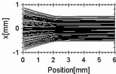
図 5: 進行方向に対するエミッタンスの変化。RFGun 空洞で増加したエミッタンスが、ソレノイド磁場によって補正されているのが分かる。
