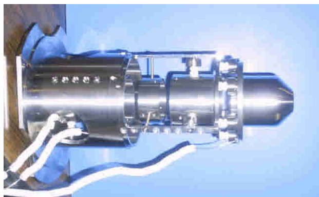
図 5 : Hyper ECR 用加減速引き出し電極ユニット。
