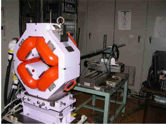
図9 4極電磁石のホール測定装置
