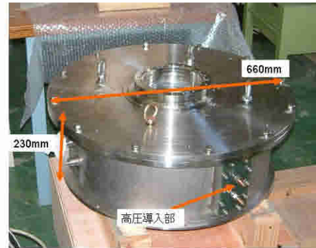
図7 誘導加速空洞(1ユニット)
