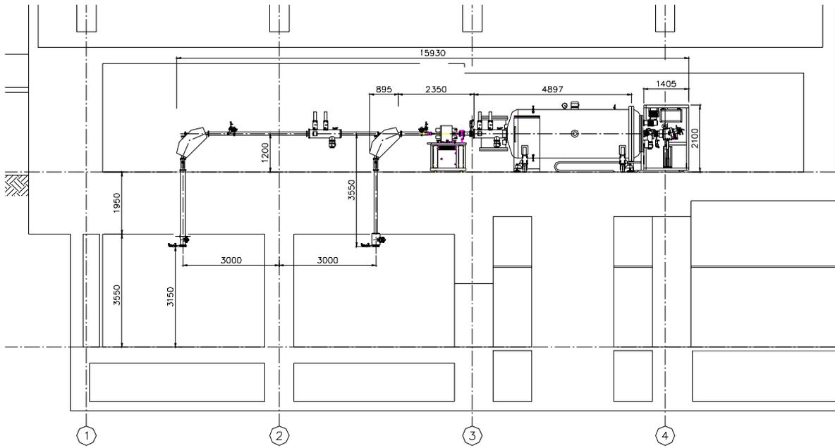
図3：タンデトロンと照射室の概略図
