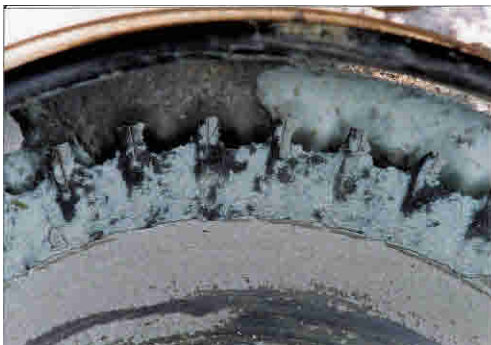
図2：エロージョン・コロージョンによりかなりの部分が消失したポンプインペラ (材質：BC1)。
