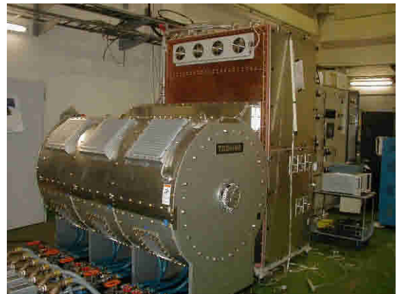
図7：MR 用加速空洞と最終段増幅器
