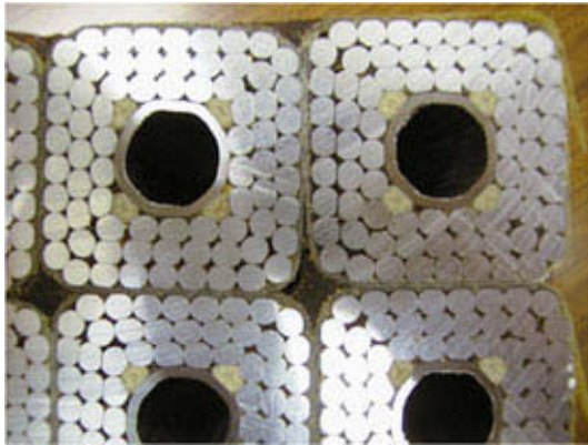
図5：ポリミド樹脂を含浸してコイルに成形された ストランド線の断面図
