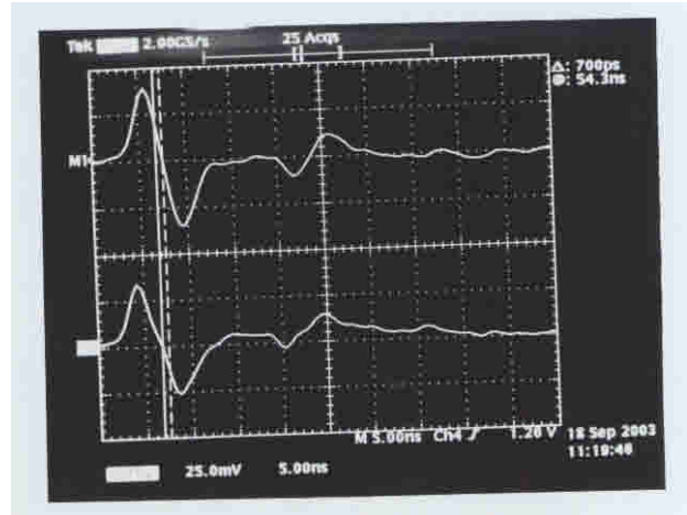
図 4 : 観測波形 (原点位置 0mm . T=70psec) ビーム条件 \alpha 4.0MeV 0.5 \mu A ch1:上流側 ch2:下流側
