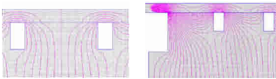
図8：(左)支持板をつけたときの中間電極2,3付近の等電位線の様子と(右)支持板をつけたときの主電極1付近の等電位線の様子
