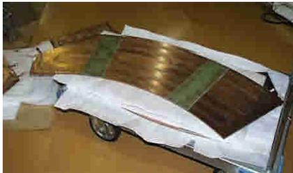
図5：断熱ジャケットの一部 (設置前)
